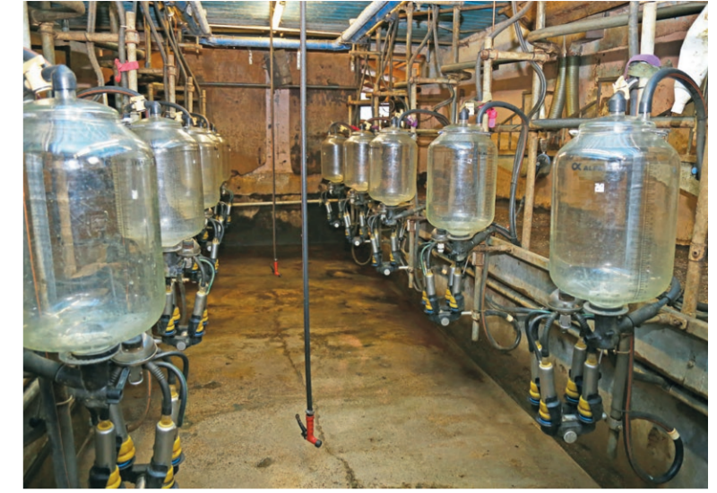
Net als de stal stamt ook de 2 x 6 stands visgraatmelkstal uit 1973. John is weliswaar voornemens een nieuwe 2 x 10 stands visgraat melkstal te bouwen, maar zegt evengoed met plezier twee keer daags 2,5 uur in de melkput te staan.
