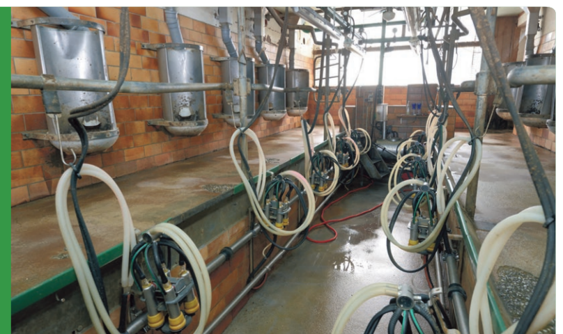
De koeien worden gemolken in een 2 x 5 stands visgraat melkstal.
