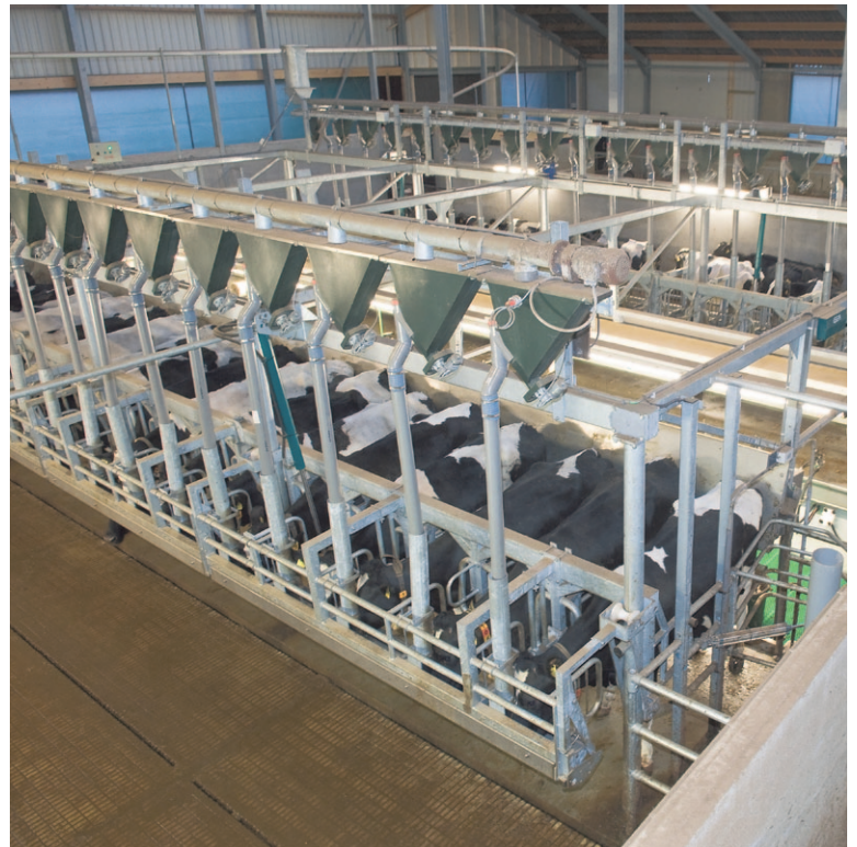
In de 2 x 18-stands rapid exit melkstal krijgen de koeien individueel krachtvoer.
